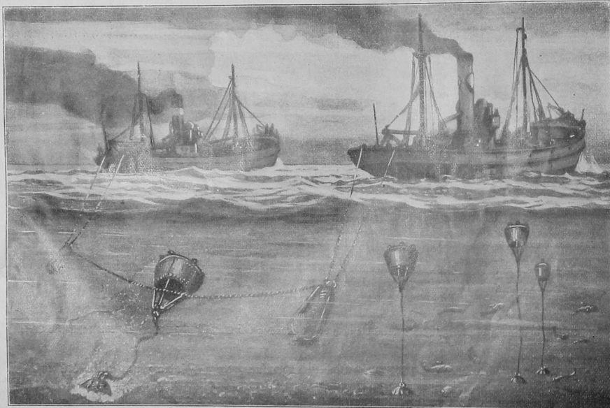
Das Minen-Schieben. Mit Hilfe von ganz flach gebauten Dampfern mit geringem Tiefgang wird eine lange Kette in entsprechender Tiefe langsam nachgeschleift und auf diese Weise können, wenn auch mit großer Gefahr, ausgelegte Minen von ihrer Verankerung losgerissen und unschädlich gemacht werden.
