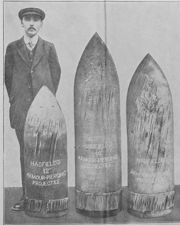
Englische schwere Schiffsgeschosse. Die Aufnahme ist gemacht nach dem Durchschlagen eines 30 cm dicken Stabpanzers. Man sieht die Spuren des Durchschlags deutlich an den Geschossen.
