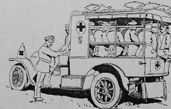
Abb. 15. Kranken-Kraftwagen mit Bänken für Leichtverwundete, Konstruktion der Daimlerwerke.
