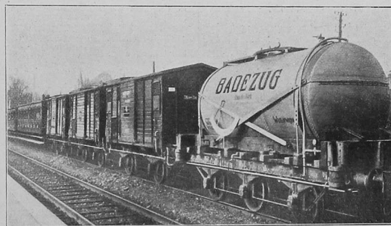
Der Badezug des 1. bayer. Reservekorps. Er besteht aus der Lokomotive, dem Wasserwagen, drei Badewagen, einem An- und Auskleidewagen und einem Wohnwagen für das Zugpersonal.
