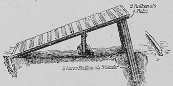
Abb. 12. Feste Seitenrampe, deren Ständerbalken eingegraben sind.
